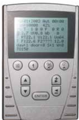
Den automatiska kontrollenheten har en PLC-servicepanel.
